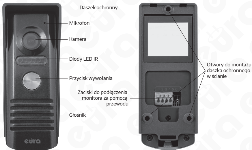
Rys. 2 Budowa kasety zewnętrznej VDA-10A3
