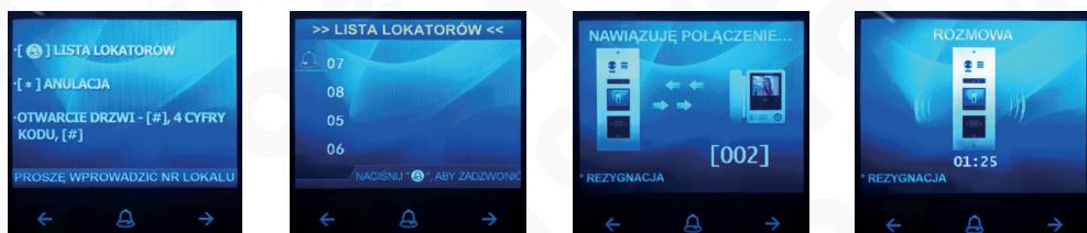
Rys. 25. Wywołanie lokatora z modułu wyświetlacza LCD VXA-65A5
