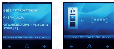
Rys. 28. Dostęp do ustawień urządzenia za pomocą modułu klawiatury szyfratora VXA-64A5
