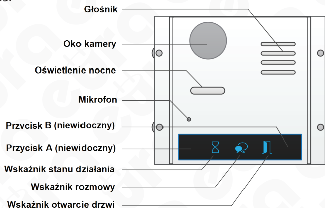
Rys. 13. Zewnętrzna budowa modułu kamery
