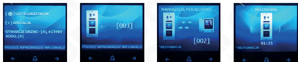
Rys. 26. Wywołanie lokatora z modułu klawiatury VXA-64A5
